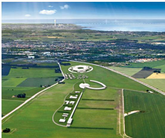
*Figur 1. Skitse af den kommende neutronkilde, ESS, i forgrunden foran røntgenanlægget MAX IV midt i billede. I horisonten ses Øresundsbroen. Protoner sendes fra helt forrest i billede gennem den lineære accelerator ind mod den mindre, runde bygning. Her banker protonerne med stor energi ind i atomkerner, så neutroner "sprøjter" ud i en stråleformet bygning. Neutronerne benyttes til materialeundersøgelser i de buede bygninger.*
