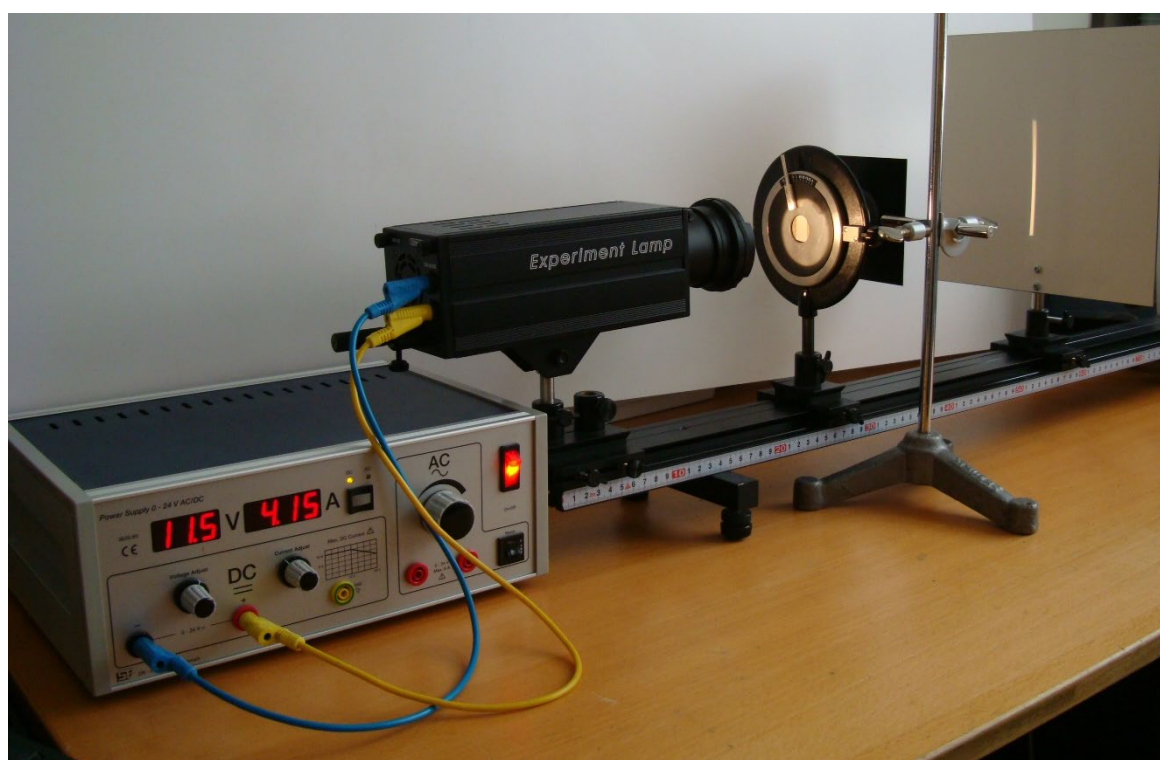
Figur 3. Opstilling til eksperiment 1 med reuterlampe, spalte og linse uden optisk gitter. Hvad vil der ske, hvis man indsætter et optisk gitter mellem linsen og skærmen?
