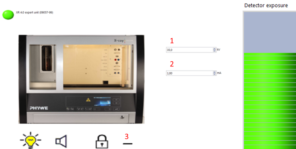
Figure 2: Her kan du slukke og tænde for røntgenkilden og styre højspændingen og emissionsstrømmen. 1: Her kan du sætte højspændingen, 2: Her sætter du emissionsstrømmen, 3: Her kan du tænde og slukke for røntgenkilden. En buet linje betyder, at røntgenkilden er tændt, en lige linje betyder, at den er slukket.
