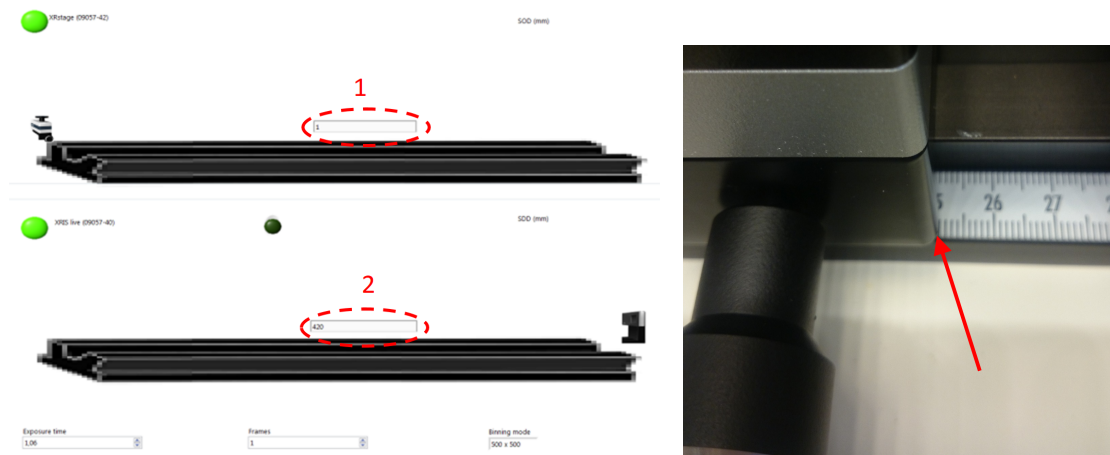
Figure 4: Angiv positionen af prøveholderen (1) og detektoren (2). Positionen skal angives i mm, og måles på bagsiden.
