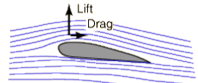
Figur 2: Luftstrømmen omkring en vinge, samt de kræfter der virker på vingen.
