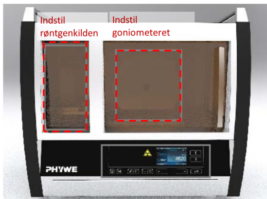
Figur 5: Klik på dette billede i "Measureprogrammet" for at indstille røntgenkilden og jeres goniometer.
