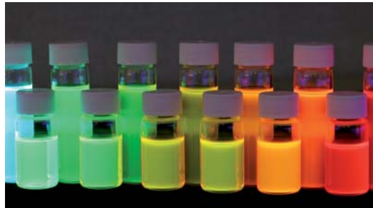
Figur 14. Venstre: Fluorescensspektrum for cadmiumtellurium (CdTe) kvantepunkter i forskellige størrelser. Højre: Kvantepunkter af forskellige størrelser og materialer har forskellige farver.
