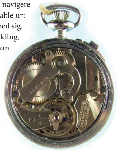
Figur 1. Lommeuret. Et af de tidligste eksempler på mikromekanik. Præcisionen i uret er tæt på grænsen for, hvad menneskets hånd og øje kan præstere.
