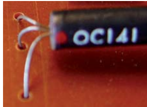
Figur 2. DASK brugte store 'radiatorrør' (venstre), som i GIER blev erstattet med de meget mindre transistorer (0,5 cm) (højre). Bemærk de tre ben på transistoren, som er metalelektroderne.
