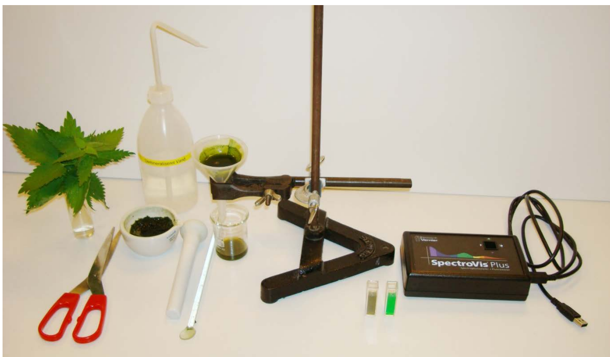
Figur 5. Udstyr til udtræk af klorofyl fra brændenælder eller spinat. Spektrofotometer til højre.
