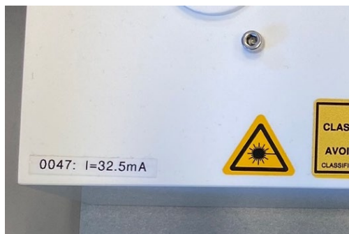
Figur 3: I dette tilfælde skal laseren bruge I=32.5\text{ mA} .
