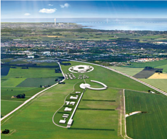
Figur 1. Skitse af den kommende neutronkilde, ESS, i forgrunden foran røntgenanlægget MAX IV midt i billedet. I horisonten ses Øresundsbroen. Protoner sendes fra helt forrest i billedet gennem den lineære accelerator ind mod den mindre, runde bygning. Her banker protonerne med stor energi ind i atomkerner, så neutroner "sprøjter" ud i en stråleformet byge. Neutronerne benyttes til materialeundersøgelser i de buede bygninger.
